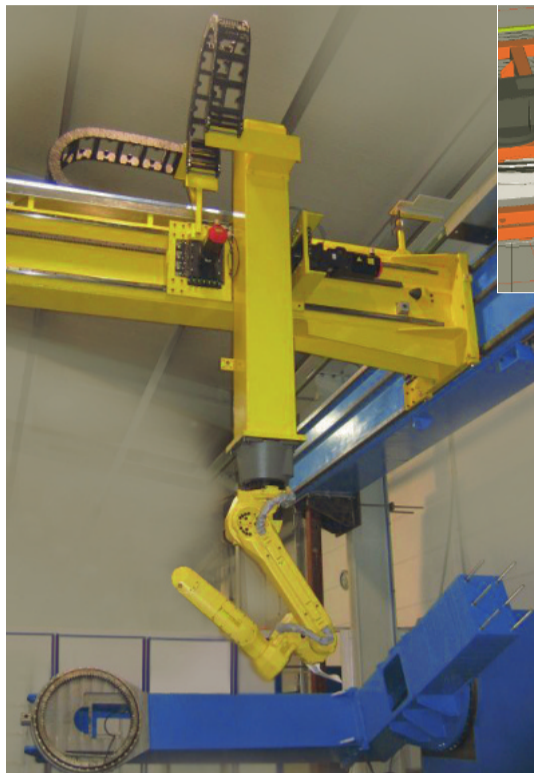
Das Portal, an dem der Roboter hängt, besteht aus einer Linearverfahreinheit, die an Hallenstützen aufgesetzt wird. Hinzu kommen eine Querverfahreinheit und ein Hubfahrwerk. Auf der für die Schweiz gebauten Anlage werden Teile von bis zu drei Tonnen manipuliert und geschweißt
